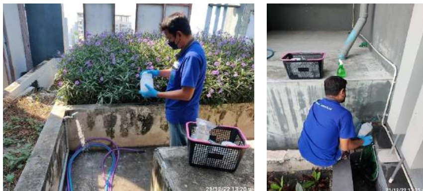
ภาพที่ 4.5-2 การตรวจวัด Total Coliform Bacteria (TCB) และ Fecal Coliform Bacteria (FCB) สระว่ายน้ำ
