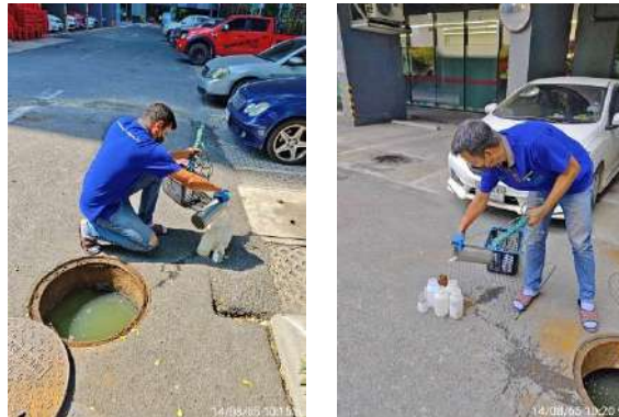
รูปที่ 4-3-1 การเก็บตัวอย่างคุณภาพน้ำทิ้ง
